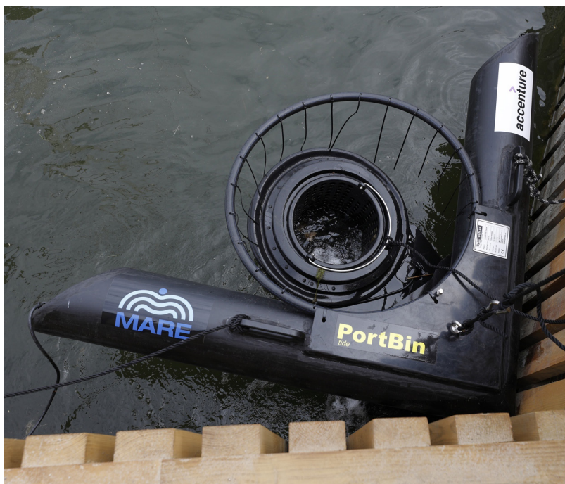
W przystani zacumował też czwarty w Gdańsku kosz Portbin, który umożliwia jak najszybsze usunięcie pływających śmieci, zanim opadną na dno. Fot. Grzegorz Mehring/www.gdansk.pl
